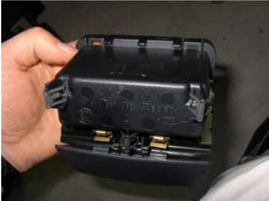
Bild 3: hintere Aschenbecheraufnahme mit Halteklammern
