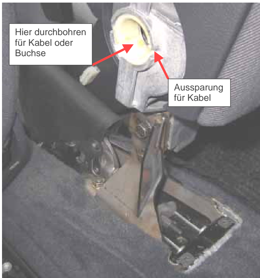
Bild 5: Montierte Armlehne ohne Mittelkonsole (siehe Aussparrung für Kabel)
