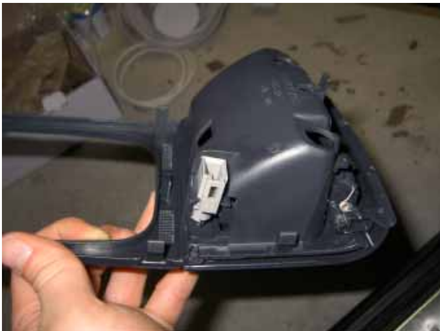
Bild 2: Vordere Aschenbecheraufnahme mit Flachkontaktgehäuse für den Stecker der Ascherbeleuchtung
